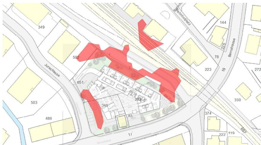
Abb. 8 Zonen mit relevanter Gefährdungsverlagerung (rot, unter Berücksichtigung der flankierenden Massnahmen.)
